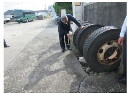
車両点検は、ブレーキ・タイヤ・灯火類・燃料など運行前後の確認が義務付けられています。疑いの目を持って点検する。また、毎日の点検の積み重ねによりわずかな変化への気づき、すなわち早期の異常発見につながります。
